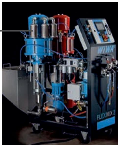
Cette génération de systèmes de mélange et de dosage multi composants à commande électronique à maintenant un moteur puissant qui est non seulement puissant mais aussi silencieux, sans huile et anti gel. Ce modèle est conçu pour avoir une haute performance. Le 2K Fleximix fournit un revêtement épais avec un haut pouvoir de couverture et vous donne la possibilité d'utiliser différentes buses ou de tuyaux en même temps. Idéal pour le traitement de la plupart des revêtements industriels.
